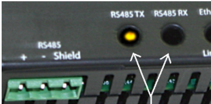
AcquiSuite EMB A8810 RS-485 LEDs
